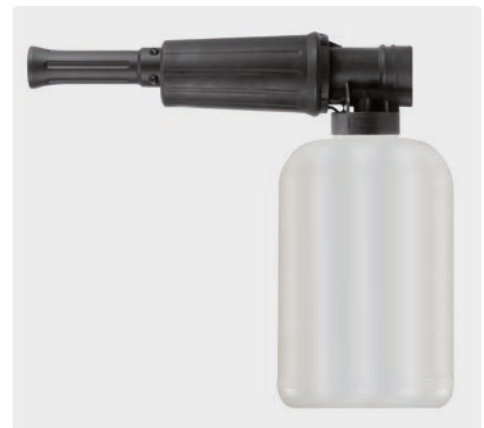
1/4" IG. Schauminjektorlanze mit Dosierung und Flasche. Ohne Pad. Max. 300 bar / 80 °C
