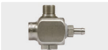
Tülle 9 mm : 1/2" AG dreh. : 1/2" IG. Edelstahl. Zum Einblasen von Druckluft. Max. 350 bar / 60 °C
