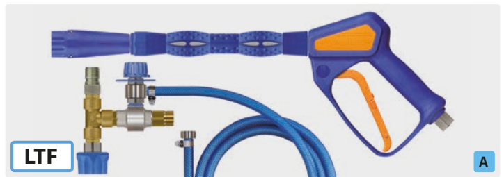
easywash365+ Schaumset: easywash365+ Schaumlanze Standard mit Schaumdüse ST-75, Injektor ST-160 (Kupplung ST-45-250 Messing vernickelt, Stecknippel ST-45-250 Stahl verzinkt und M22 AG) mit Dosierventil ST-161, Saugschlauch 1.000 mm und Saugfilter ST-32. Max. 250 bar / 90 °C
