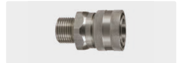
Kupplung : AG. Edelstahl. 60° Dicht- konus. Max. 250 bar / 150 °C
